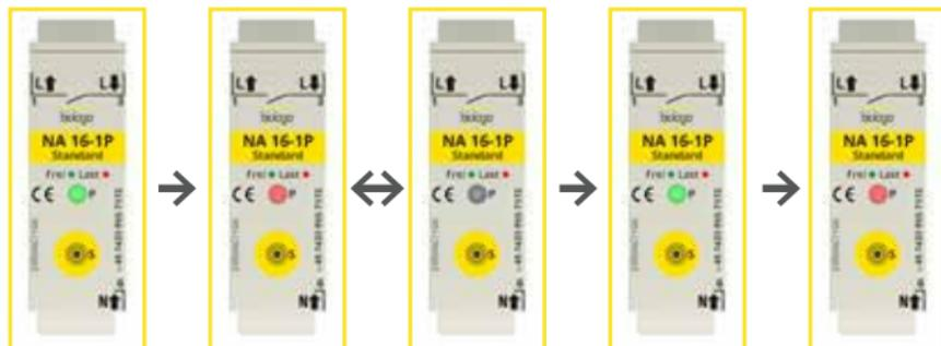
Um alle Sender auszulernen (abzumelden) berühren Sie den Touchsensor „S“ lang (ca. 20-30sec.). Die LED „P“ blinkt daraufhin erst orange, dann rot. Lassen Sie den Sensor los. Der NA 16-1P Funk initialisiert sich neu und befindet sich wieder im Automatikmodus (NA 16-1P Standard - siehe Seite 6)
