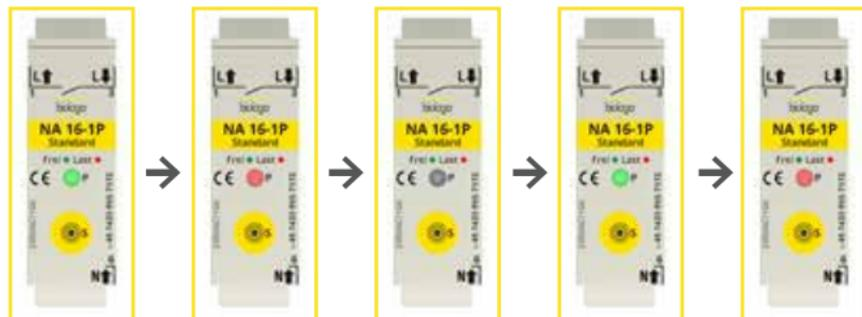
Nach dem Trennen aller Verbraucher des zu schaltenden Stromkreises und dem Zuschalten der Sicherung initialisiert sich der NA und lernt sich ein.
