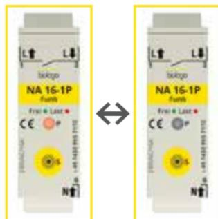
Nach der Initialisierung berühren Sie den Touchsensor „S“ solange, bis die Kontroll-LED „P“ orange blinkt.
